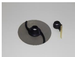
Abbildung 6: Auswurfteiler und Auswerfer
